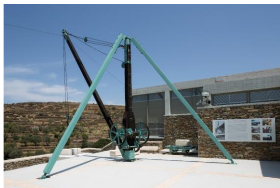
Εικόνα 22. Υπαίθριος χώρος Μουσείου: ανυψωτική μηχανή μαρμάρων (μπίγα), και βαγονέτο με στροφή και ράγες.
