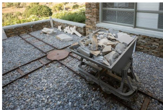
Εικόνα 22. Υπαίθριος χώρος Μουσείου: ανυψωτική μηχανή μαρμάρων (μπίγα), και βαγονέτο με στροφή και ράγες.
