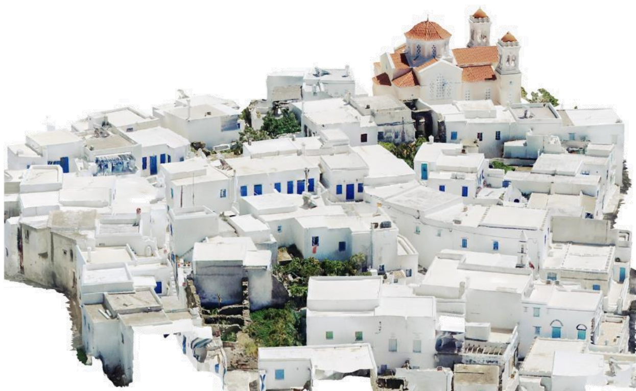
Εικόνα 12. Τρισδιάστατη αποτύπωση του οικισμού του Πύργου, προϊόν φωτογραμμετρίας με χρήση drones (ΕΕ2).
