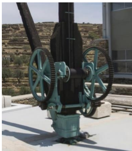
Εικόνα 18. Αριστερά: οι 3 άξονες κίνησης της μπίγας (Πηγή 2 , cc-by-nc-sa). Δεξιά: μία πιο κοντινή ματιά στη βάση του μηχανισμού.
